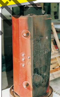
Катушка трансформатора Trihal после испытания F1
