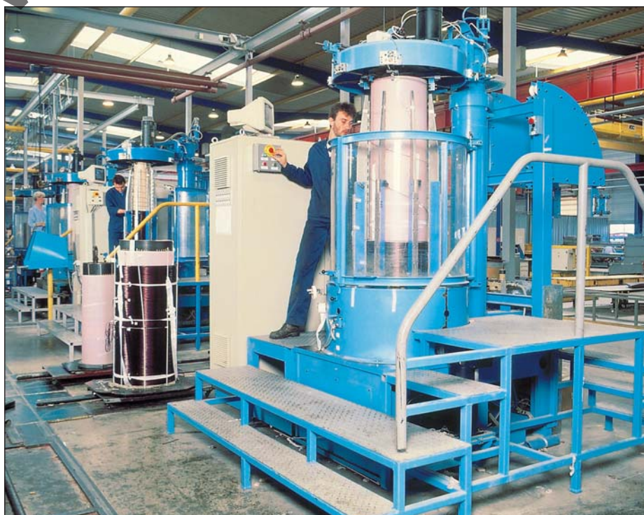
Намотка обмотки высокого напряжения
