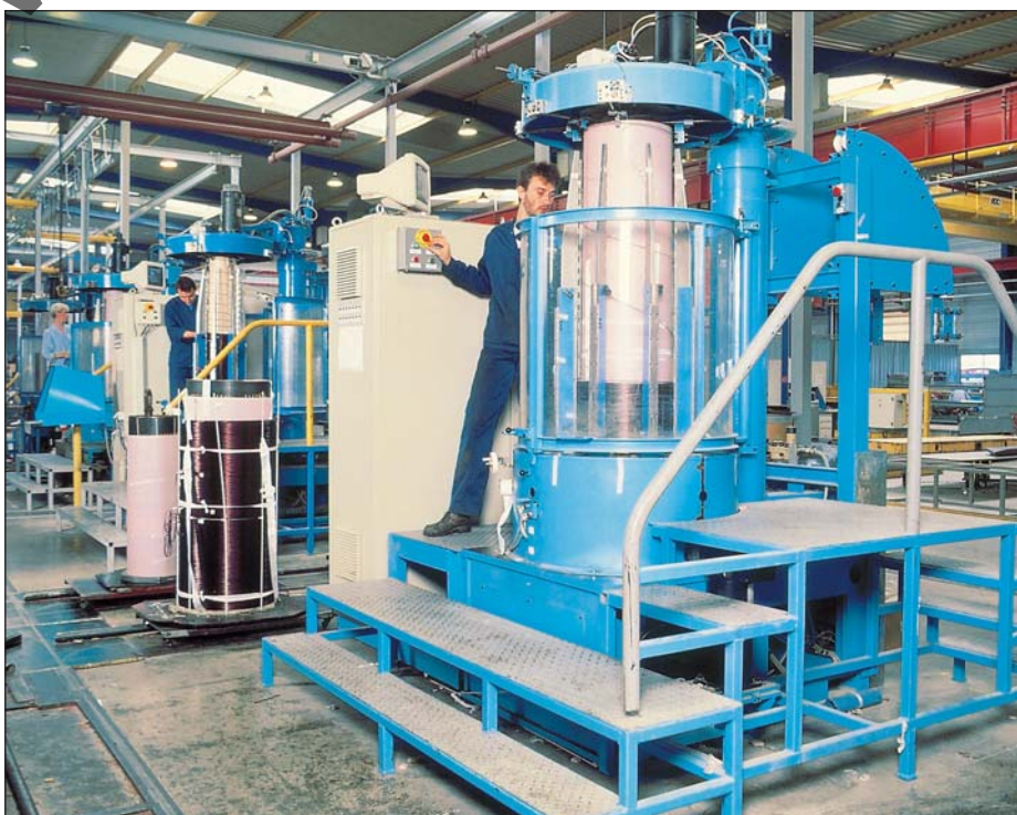
Намотка обмотки высокого напряжения
